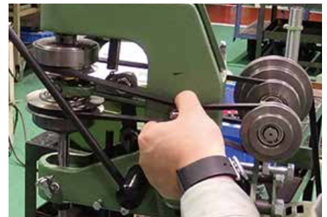
⑥ Vベルトを写真の状態に調整して、ナットをしめる
