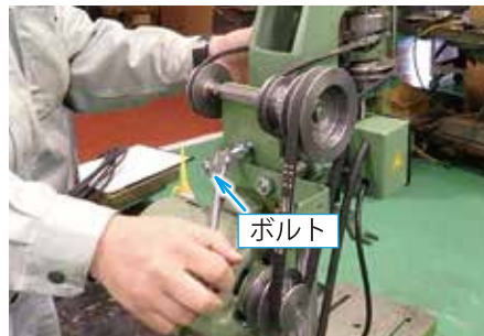
⑤ 手で、Vベルトの張り具合をみながら、ボルトで調整する
