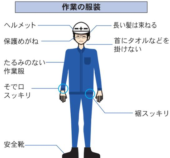
作業を行う時、ボール盤の主軸は回転しているため服などを巻き込み重大な事故につながる可能性があります。巻き込まれない安全な服装で作業を行ってください。特に、手袋を着用しての作業は「巻き込まれ事故」の大きな原因となっています。
