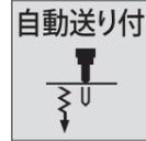
ハンドルを任意の位置で横へ倒すと送りクラッチが入り自動送りします。送り機構は安全装置付きで、過負荷から機械を保護します。
